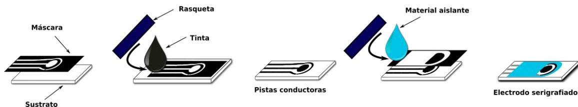
Figura 1.7: Esquema de las etapas de fabricación de electrodos serigrafiados.
