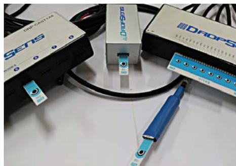
Figura 1.5: Diferentes conectores para electrodos serigrafados.
