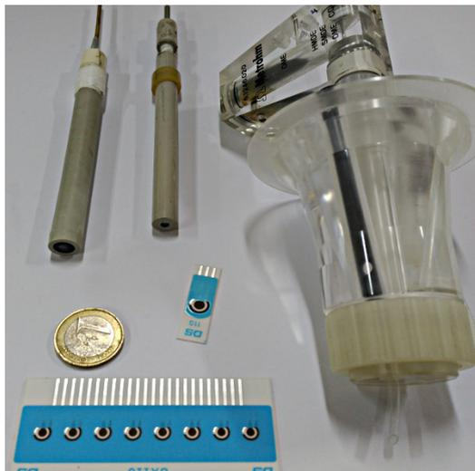
Figura 1.2: Electrodo convencionales de mercurio, pasta y carbono vítreo junto a electrodos serigrafiados desechables.
