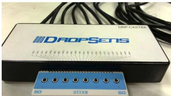
Figura 2.1: Imagen de una tarjeta serigrafiada de 8 canales y su conector correspondiente.
