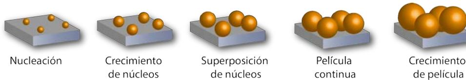
Figura 1.25: Esquema de la nucleación y crecimiento de nanopartículas por electrodeposición siguiendo el modelo de nucleación instantánea.
