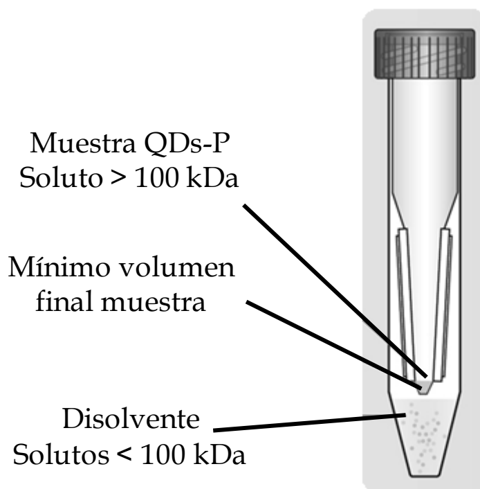
Figura 18. Filtros de membrana (Amicon, Centricon) para la ultracentrifugación.
