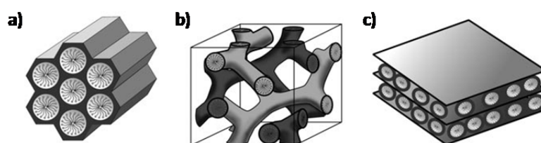
Figura 2. Ilustración de las posibles estructuras de los materiales mesoestructurados de sílice: a) hexagonal 2D (MCM-41, con grupo espacial p6mm ), b) cúbico 3D (MCM-48, con grupo espacial la3d ) y c) laminar (MCM-50, con grupo espacial p2 ).
